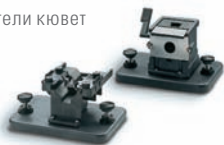
Держатель кювет с термостатированием на основе эффекта Пельтье
